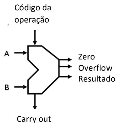
Os valores de A e B e o códigos de operação deverão estar previamente armazenados em uma única memória ROM inicializada via arquivo .mif ou .hex. Os sinais de controle da memória serão gerados manualmente pelas chaves existentes na placa de FPGA, conforme detalhes vistos nas aulas de laboratório.
