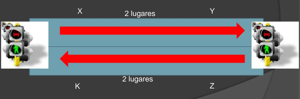
Em um estacionamento com 4 lugares, com entrada única pela garragem com sensor X, e saída pela garagem com sensor Z. O Sistema deve ser tal que se um carro para em X, nenhum carro pode mais entrar e consequentemente luz vermelha na entrada. Caro contrário, ir ocupando os espaços até o máximo de 4 lugares.
