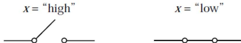
(a) Switch com comportamento oposto da Figura 2(a)
