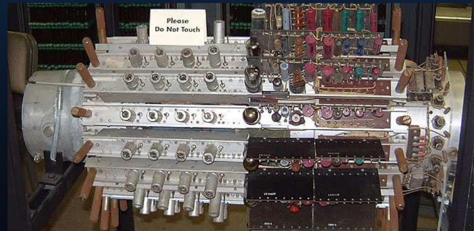
Memórias de Mercúrio do UNIVAC I (1951): acesso serial
