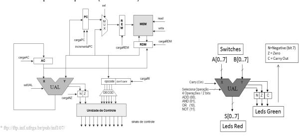
A implementação da ULA do Neander em FPGA consiste de uma ULA de 8 bits (bits 0 a 7), onde podem ser executadas 4 operações básicas conforme a seleção: ADD (Soma=00), AND (E bit-a-bit=01), OR (Ou bit-a-bit=10) e NOT (Inverte bits=11).
