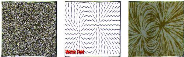
Figura: A textura a esquerda é combinada com o campo vetorial no centro, gerando a imagem a direita.
